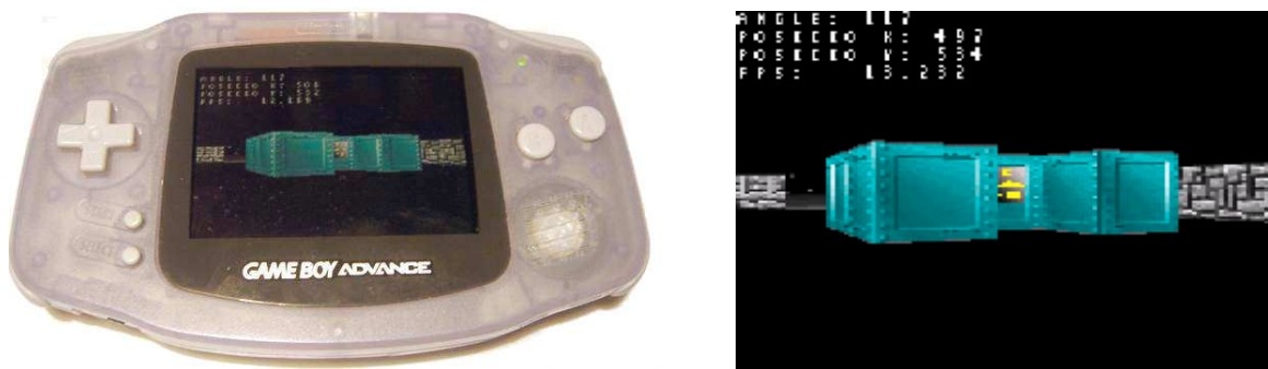
Figura 6.1 Execució del primer motor sobre la GBA, un ray-casting amb mapa de cel·les a la GBA (dreta) i a l'emulador de GBA (esquerra).
