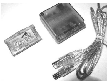
Figura 1.5 Eina EZ-Flash II. En ella inclou el gravador de roms i un cartutx gravable per GBA.
